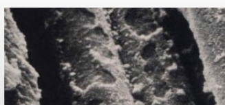
Figura 3. Superfície da fibra de vidro E corroída antes de sua imersão em uma solução de cal
