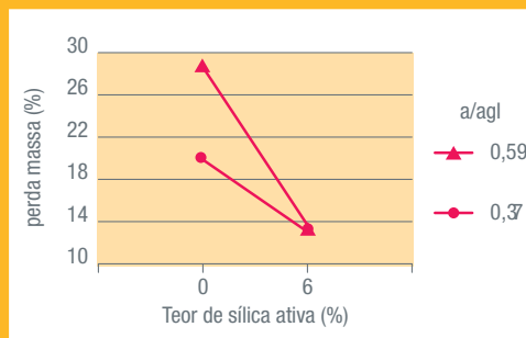
Figura 3. Perda de massa para agressão com ácido láctico
