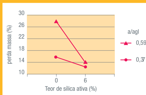
Figura 4. Perda de massa para agressão com ácido fórmico
