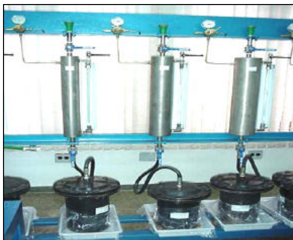
Fotografia 1 – Permeômetros usados no ensaio de permeabilidade e adaptados para o ensaio de lixiviação.
