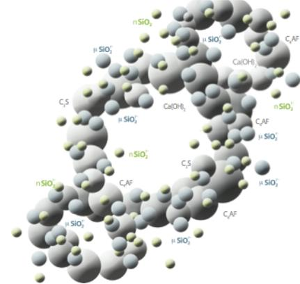
**Silicon ns ad 400** é um aditivo líquido superplastificante à base de policarboxilato modificado com nanosílica estabilizada.
